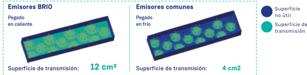
Nuestro sistema de pegado en caliente nos proporciona una superficie de transmisión tres veces superior a la convencional. En la comparativa se observa como la superficie de transmisión no se reduce a la superficie circular de los transductores, sino que se extiende a toda la superficie de transmisión del emisor.
