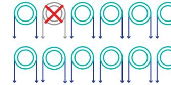
Se pierde el rendimiento de un solo transductor. El emisor sigue funcionando.
